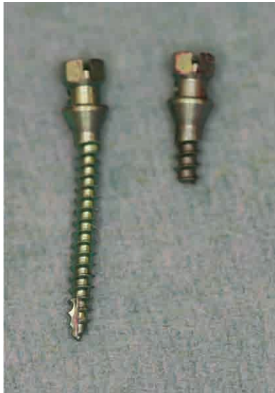
Figure 20 Fracture d'une minivis Tekka®. Déformation d'une minivis Tekka® suite aux actions de pose et dépose (tests réalisés sur tête de porc, docteur Le Gall).
