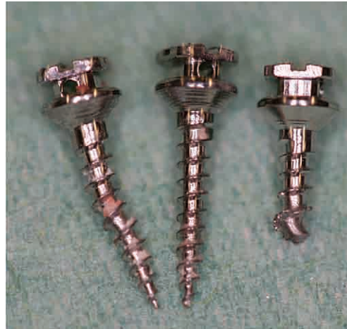
Figure 21 Fracture d'une minivis HDC® (à droite). Déformation d'une minivis HDC® suite aux actions de pose et dépose (à gauche). Minivis HDC® non utilisée (au centre) (tests réalisés sur tête de porc, docteur Le Gall).
