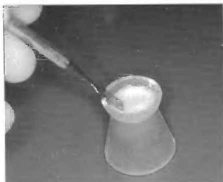
Fig. 1-2 Le mélange est effectué avec une spatule à ciment pour obtenir une pâte fluide et homogène
