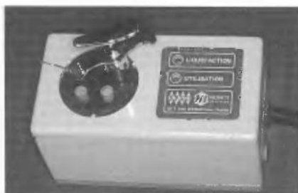
Fig. 2-8 Le conditionneur est branché une heure avant l'intervention. Le corps de la seringue est préchauffé ainsi que les aiguilles d'injection
