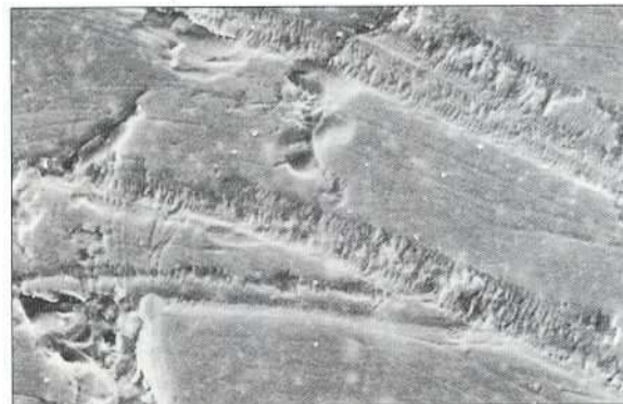
14.12 Traces d'usure sur une surface céramique glacée (photographie par microscope électronique à balayage).
