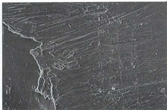
14.9 Usure abrasive des alliages à base d'or (photographie par microscope électronique à balayage).
